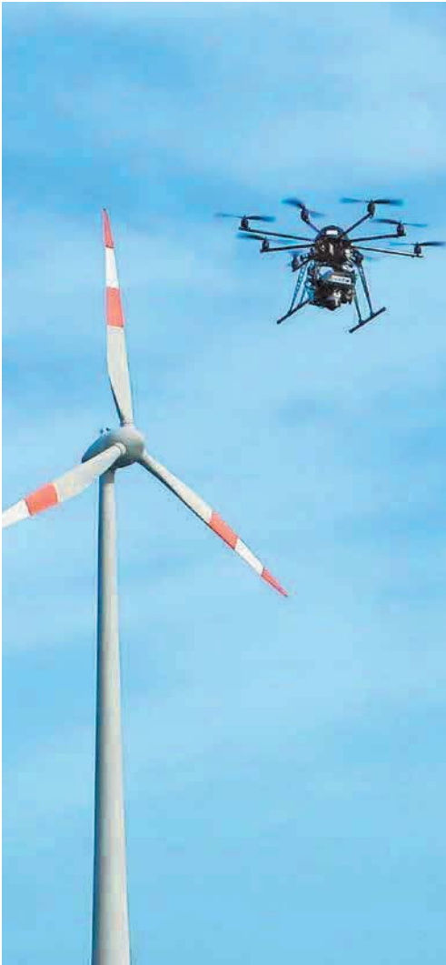
Per Drohne kann der Serviceanbieter Availon Rotorblätter inspizieren.
