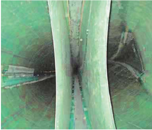
Innenblattinspektion per Kamera. FOTO: REETEC
